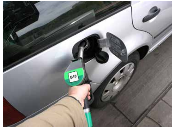
Ab April 2024 kann der neue Kraftstoff B10 an Tankstellen in Deutschland angeboten werden. Mit B10 wird ein Dieseldieselkraftstoff bezeichnet, dem bis zu zehn Prozent Biodiesel beigemischt werden. Foto: DJD/Verband der Deutschen Biokraftstoffindustrie
