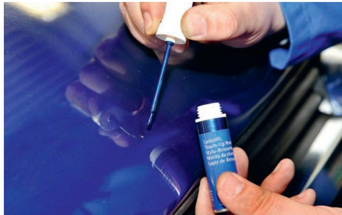
Kleine Steinschläge im Lack lassen sich per Smart-Repair unsichtbar machen.
